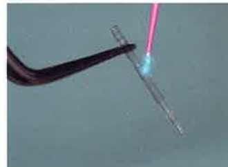
図3 アルコールワット等でポスト表面を清掃したのち、ボンドマー ライトレスを塗布、エアードライ。
